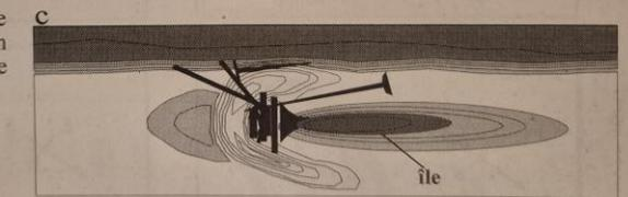
D. Le processus d'accumulation de sédiments et de troncs finit par fixer l'île à la marge du lit mineur.
