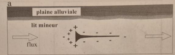
B. Formation d'un banc de sédiments en arc de cercle accompagné d'une mouille au pied des racines de l'arbre. À l'aval des dépôts sédimentaires s'accumulent le long du tronç.
